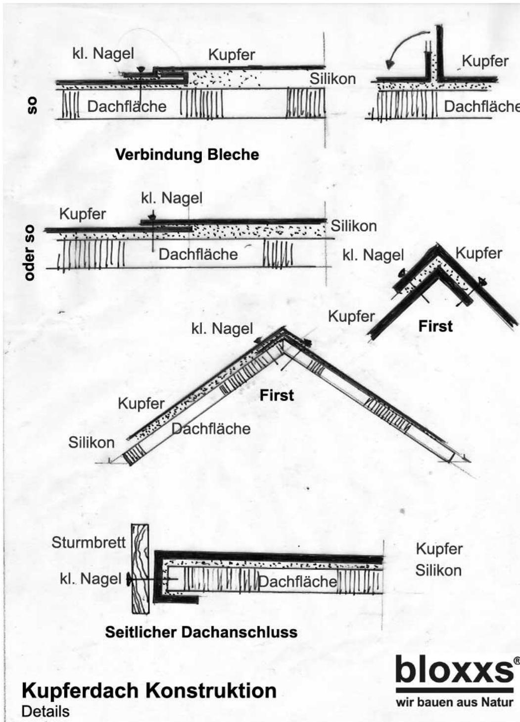
Lassen Sie jeweils an den Stoßkanten das Blech ca. 10mm – 15mm überlappen. Kleben Sie das Blech mit Bad-Silikon auf den Untergrund. Am seitlichen Dachrand um das Dach herumziehen, verkleben und durch das sogenannte Sturmbrett nageln. Im Firstbereich in beide Richtungen über den First ziehen, verkleben und nageln.
